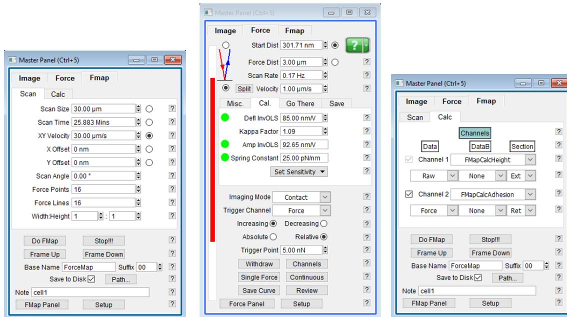
(a) Fmap tab showing Scan sub-tab parameters
